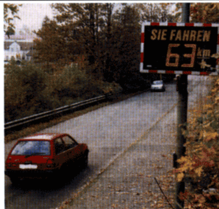
In drei Meter Höhe hängt die Messstation auf der Kenkhauser Straße und zeigt den Autofahrern an, wie schnell sie unterwegs sind – 50 sind erlaubt. BM-Foto: Dörner
